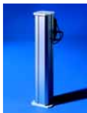
Электрическая подъемная колонна Регулировка по высоте (от 670 до 1140 мм), привод шпинделя зафиксирован от непреднамеренного опускания.
